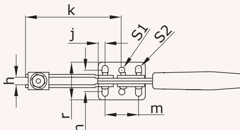
Yüksek kaliteli çelik sac aksamı, Isıl işlemli, yağlanmış yataklama burçları ve Paslanmaz Perçinler, Kolay kavranabilen ergonomic, plastik kol özellikleri ile CLAMP Hızlı Bağlama Elemanları kolay çözümler sunar...
